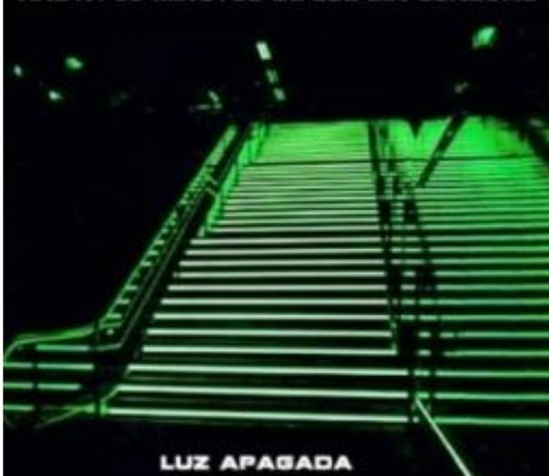
La **Fotoluminiscencia** está basada en el principio básico de emisión de luz por la absorción previa de radiación. Gracias a esta propiedad y a la capacidad de almacenamiento y memoria de la lámpara, la energía lumínica recibida previamente por **10 minutos**, vuelve a ser devuelta en condiciones de baja visibilidad o total oscuridad. Es decir, absorbe la luz para luego suministrarla cuando se necesita.
